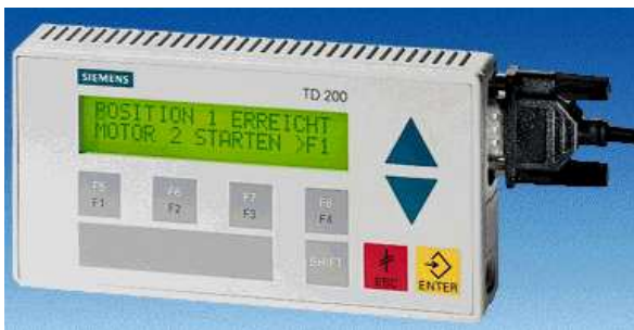
Eingabegerät Siemens TD200. Ablesen von Laufzeiten der Aggregate, Veränderung der Prozeßzeiten und Fehlermeldungen im Klartext sind möglich.
